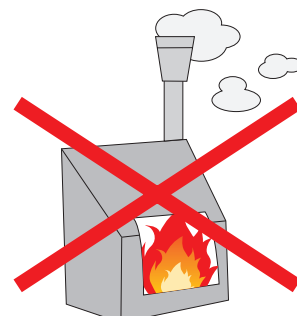
×投入口から炎や煙が出るような焼却炉
